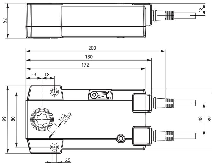
**Электропривод для управления противопожарными нормально открытыми (огнезадерживающими) клапанами небольших размеров, установленными в системах кондиционирования, общеобменной, местной и технологической вентиляции. Совмещенный с термоэлектрическим размыкающим устройством ВАТ (72°С)**
