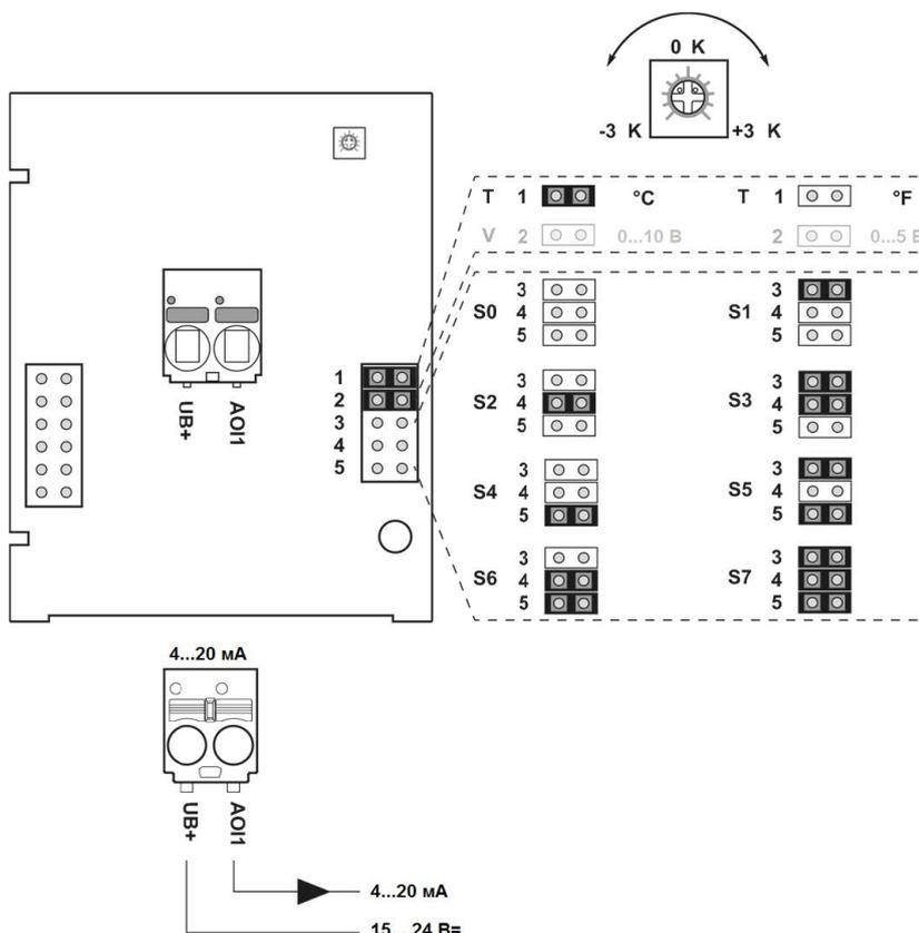
Регулировка диапазонов измерений производится путем изменения переключек. Выходное значение в новом диапазоне измерений доступно через 2 секунды.
