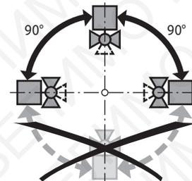
**Установка Kvs.** Угол поворота привода может быть настроен с шагом 2.5°. Это используется для установки величины kv (максимальный расход крана). Отделить ограничитель и установить его в требуемое положение.
