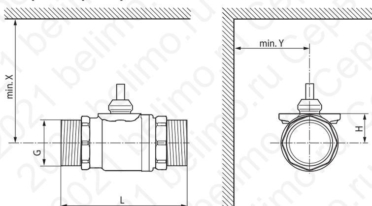
X/Y: Максимальная глубина вкручивания
