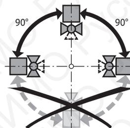
**Установка Kvs.** Необходимо отсоединить ограничитель. Это делается для того, чтобы полный угол поворота составлял 90° и кран мог выполнять свои перекидные функции.
