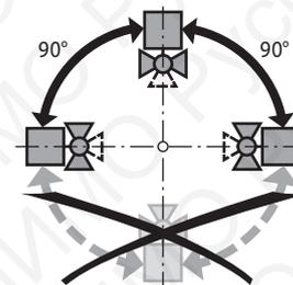
**Установка Kvs.** Необходимо отсоединить ограничитель. Это делается для того, чтобы полный угол поворота составлял 90° и кран мог выполнять свои перекидные функции.
