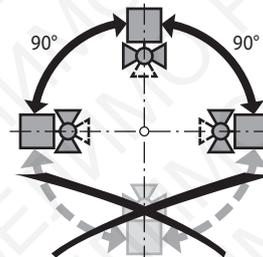
**Установка Kvs.** Угол поворота привода может быть настроен с шагом 2,5°. Это используется для установки величины kv (максимальный расход крана). Отделить ограничитель и установить его в требуемое положение.
