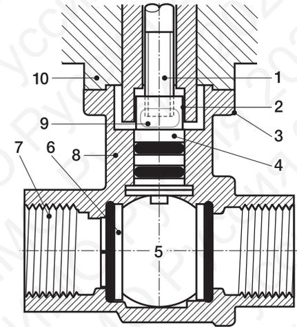
5. Корректирующий диск, обеспечивающий равнопроцентную характеристику потока
