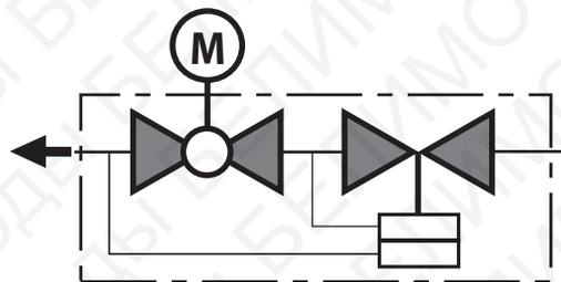
**Ограничение расхода.** Несмотря на применение электропривода, кран может быть настроен с помощью ограничителя расхода таким образом, чтобы через теплообменник в любом случае проходило некоторое количество теплоносителя.
