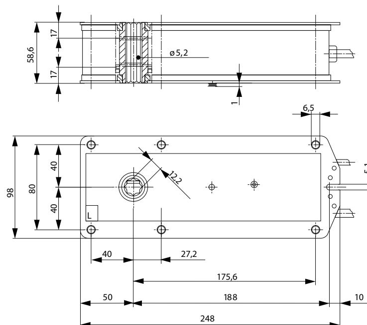
**Электропривод для управления противопожарными нормально открытыми (огнезадерживающими) клапанами, установленными в системах кондиционирования, общеобменной, местной и технологической вентиляции. Совмещенный с термоэлектрическим выключающим устройством с кнопкой тестирования ВАЕ72B-S**
