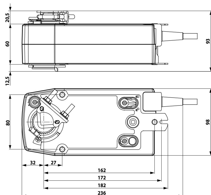
**Электропривод для управления воздушными заслонками, выполняющими охранные функции в системах вентиляции и кондиционирования воздуха зданий**
