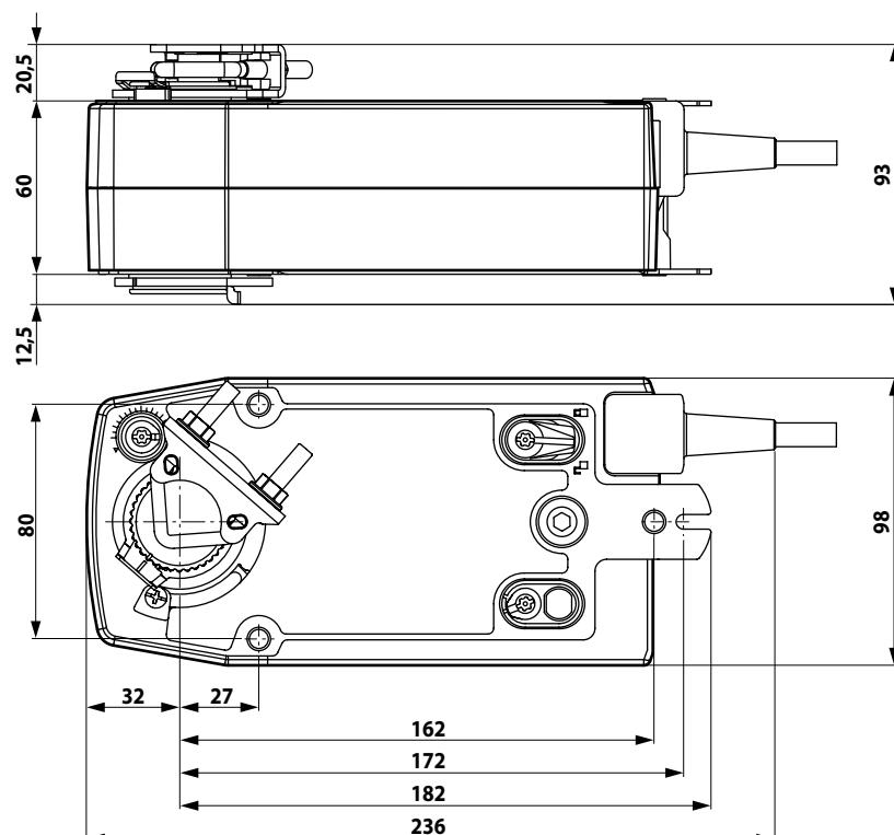
**Электропривод для управления воздушными заслонками, выполняющими охранные функции в системах вентиляции и кондиционирования воздуха зданий**
