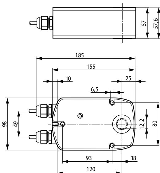
Электропривод предназначен для установки на противопожарных нормально-закрытых и дымовых клапанах систем противодымной вентиляции
