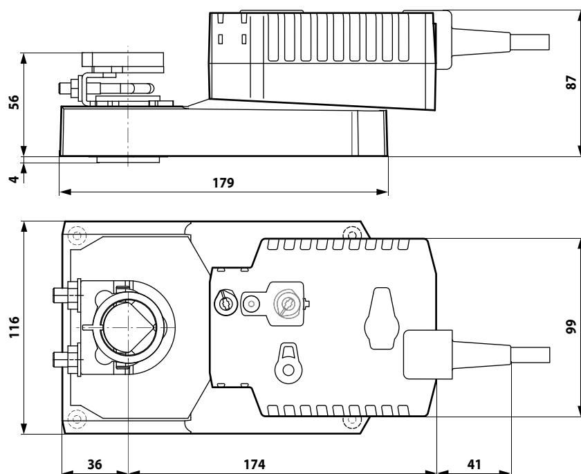
**Электропривод со встроенным конденсатором для управления воздушными заслонками, выполняющими охранные и другие дополнительные функции в системах вентиляции и кондиционирования воздуха зданий и лабораторий**
