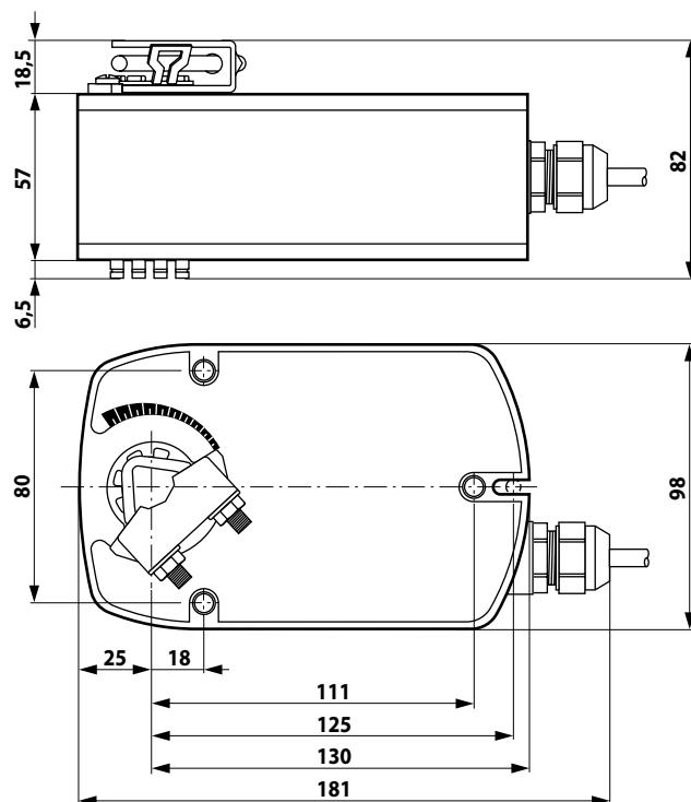
**Электропривод для управления воздушными заслонками, выполняющими охранные функции в системах вентиляции и кондиционирования воздуха зданий**
