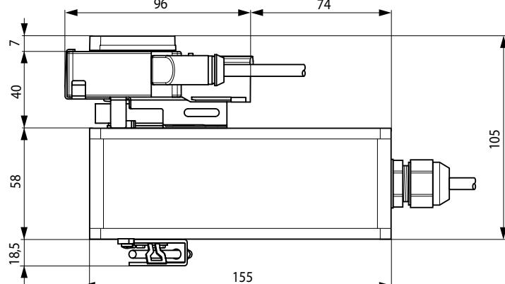
**Позиционеры для управления приводами плавной регулировки с управляемым сигналом 2...10 В= или 0...10 В=**
