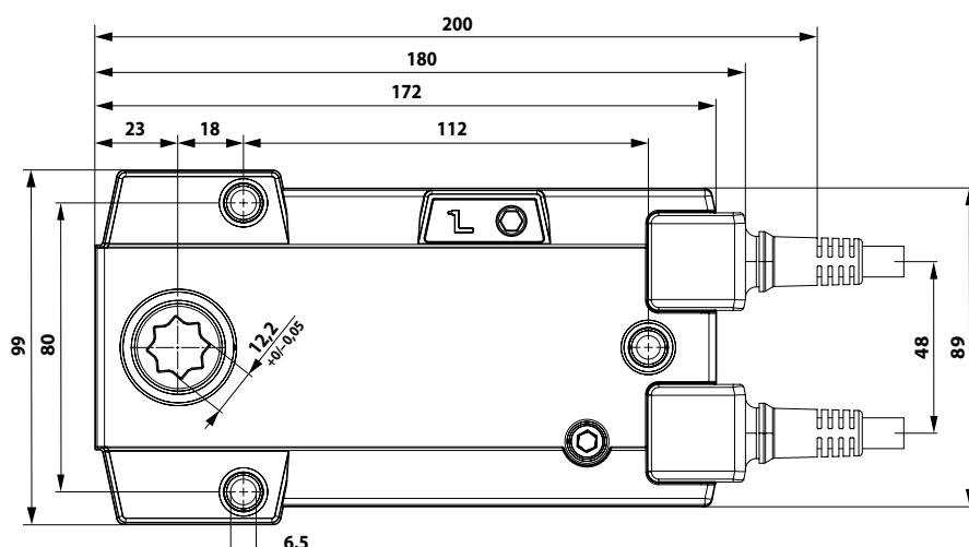
**Электропривод предназначен для установки на противопожарных нормально-закрытых и дымовых клапанах систем противодымной вентиляции**
