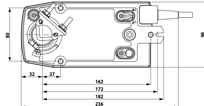
**Электропривод для управления воздушными заслонками, выполняющими охранные функции в системах вентиляции и кондиционирования воздуха зданий**
