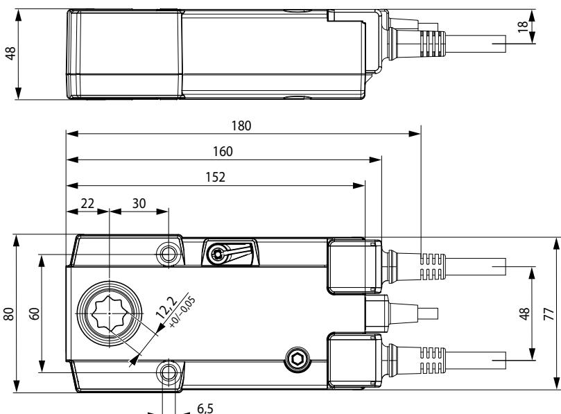
**Электропривод для управления противопожарными нормально открытыми (огнезадерживающими) клапанами небольших размеров, установленными в системах кондиционирования, общеобменной, местной и технологической вентиляции.**
