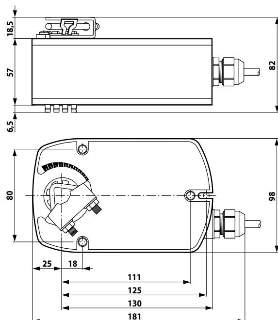
Электропривод для управления воздушными заслонками, выполняющими охранные функции в системах вентиляции и кондиционирования воздуха зданий (например защита от замораживания)
