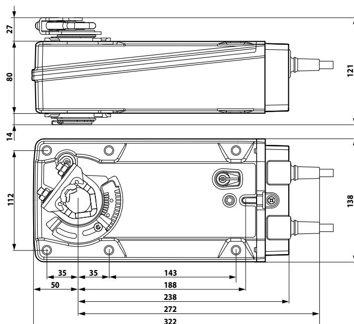
**Электропривод для модуля SKM230-T-B12
