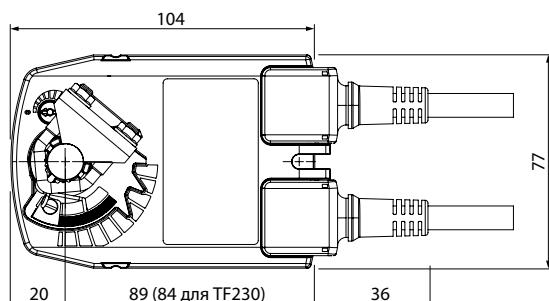
**Электропривод для управления воздушными заслонками, выполняющими охранные функции в системах вентиляции и кондиционирования воздуха зданий (например защита от замораживания)**
