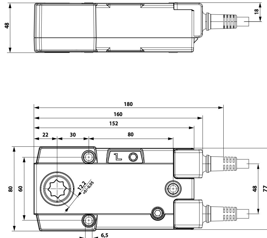
**Электропривод предназначен для установки на противопожарных нормально-закрытых и дымовых клапанах систем противодымной вентиляции**
