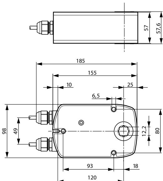
**Электропривод без возвратного пружинного механизма для установки на противопожарных нормально-закрытых и дымовых клапанах систем противодымной вентиляции**
